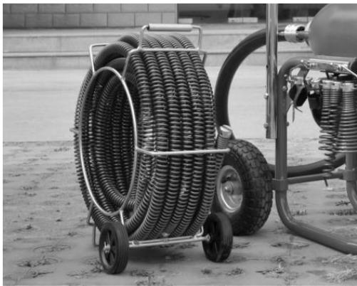
8) Как только засор устранен, поверните переключатель в положение OFF. Вытяните гибкий вал из трубы. После использования тщательно промойте и слейте воду из гибкого вала, муфты и насадки, чтобы избежать повреждающего действия некоторых составов для очистки сливов. Вытрите их насухо. Сохраните для дальнейшего использования.
