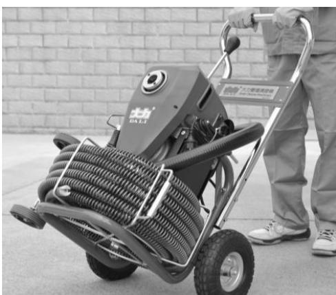
9) После использования позвольте мотору свободно работать 2-3 минуты. Впрысните смазочное масло в масляные отверстия. Можно использовать машинное масло. Уберите машину в сухое место для использования в будущем.
